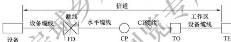
图 3.3.2 配线子系统缆线划分
